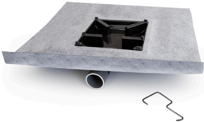
Sumidero para evacuación de agua en balcones, incorpora lámina impermeabilizante **ECODRY50** adherida en todo su perímetro por lo que lo hace 100% estanco. Fabricado para instalar a nivel de suelo terminado y lograr una correcta evacuación de agua sin interrumpir la continuidad visual de la cerámica de acabado. Recibe el agua de dos o más pendientes y la evacúa a través de las juntas entre cerámica.
