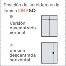
Kit de canaleta lineal preparada para revestir, con lámina DRY50 termosellada al sumidero PREMIER.
