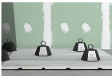
14. Colocamos peso encima del **PLATO LEVEL** repartiendo bien las cargas. Muy importante poner el peso siempre sobre la cerámica colocada, nunca directamente encima del plato. Volvemos a comprobar que este todo a nivel. Esperamos a que esté el cemento cola totalmente fraguado para retirar el peso.
